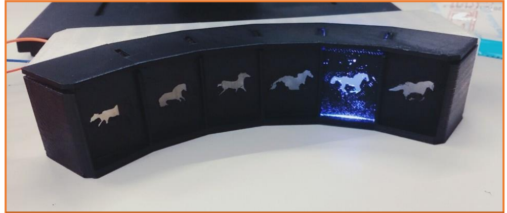
스마트 미니 영사기: 3D프린터를 활용한 출력물과 오렌지보드(아두이노)를 결합하여 움직이는 영상을 재현(암전 시, 움직이는 영상으로 출력됨)
